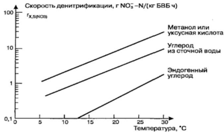
Рис. 3 Зависимость удельной скорости денитрификации от температуры при использовании различных источников углерода
