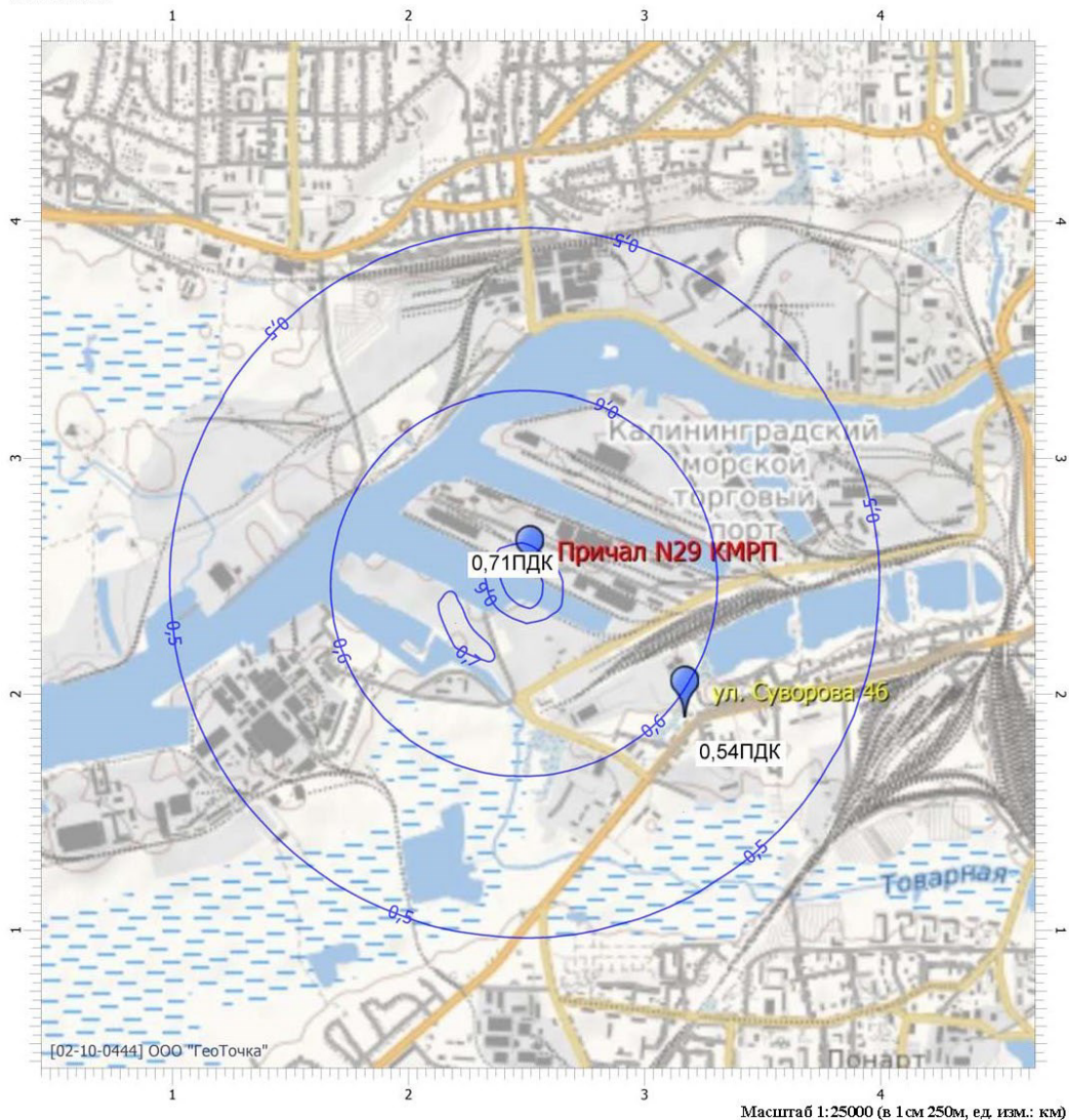
Рисунок 5.9. Схема концентраций при рассеивании диоксида азота в атмосфере в ситуации бункеровки на акватории на акватории порта Калининград (КМРП)
