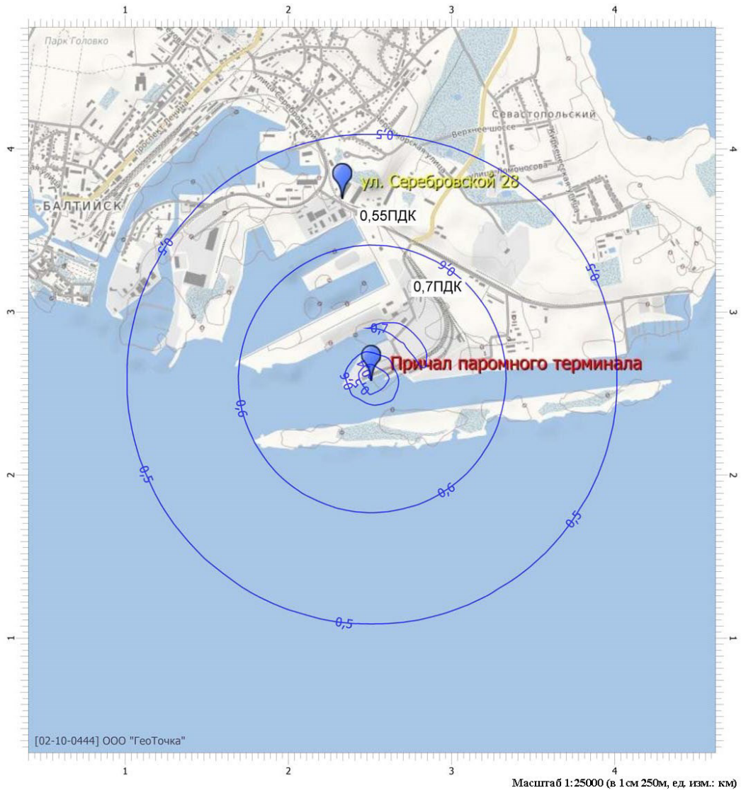
Рисунок 5.12. Схема концентраций при рассеивании диоксида азота в атмосфере в ситуации бункеровки на акватории порта Балтийск
