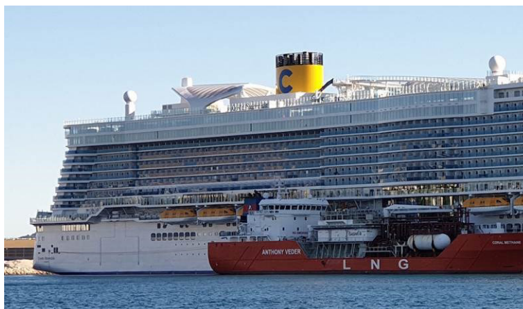
Рисунок 2.26. Бункеровка СПГ борт в борт (STS)
