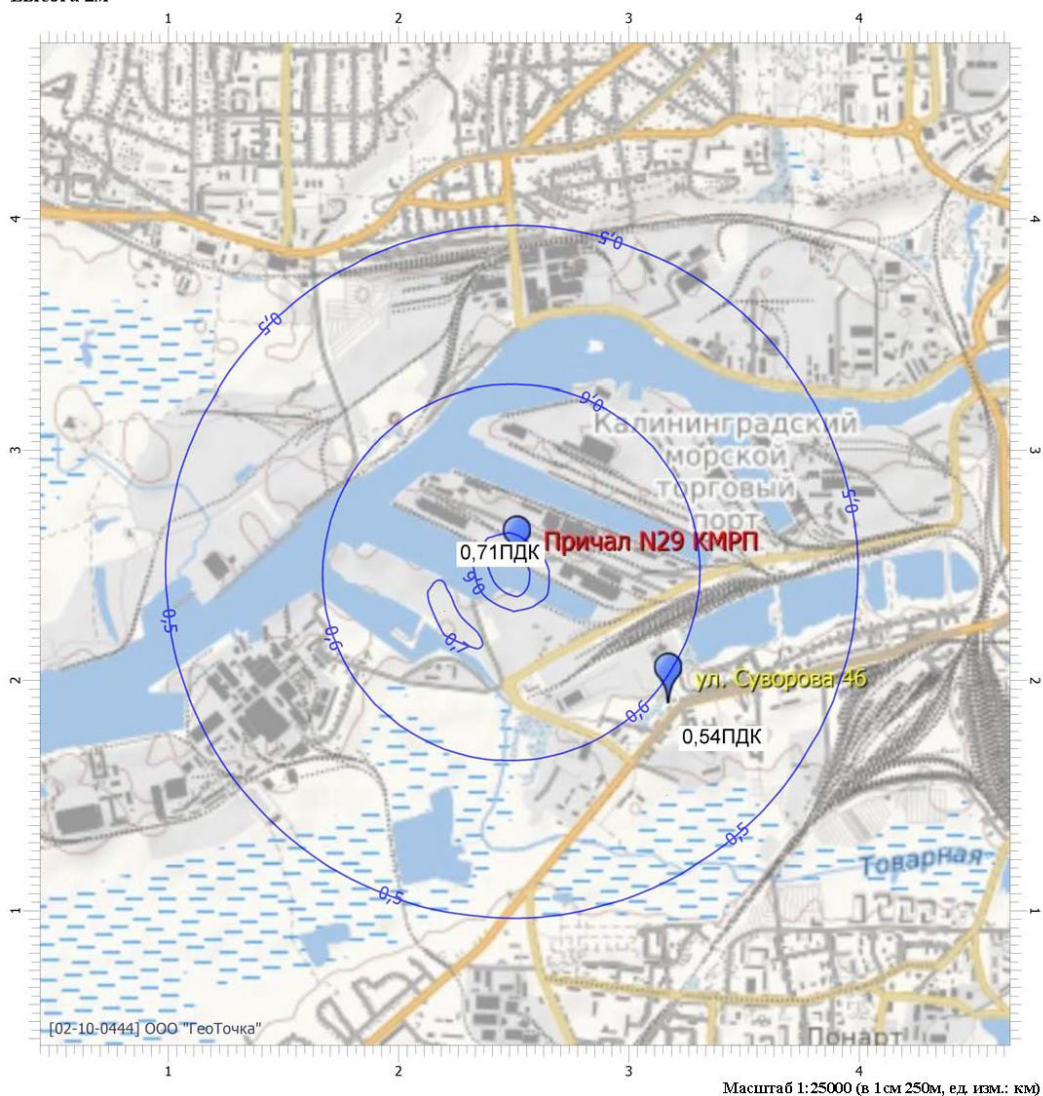
Рисунок 5.10. Схема концентраций при рассеивании диоксида азота в атмосфере в ситуации бункеровки на акватории на акватории порта Калининград (КМТП)
