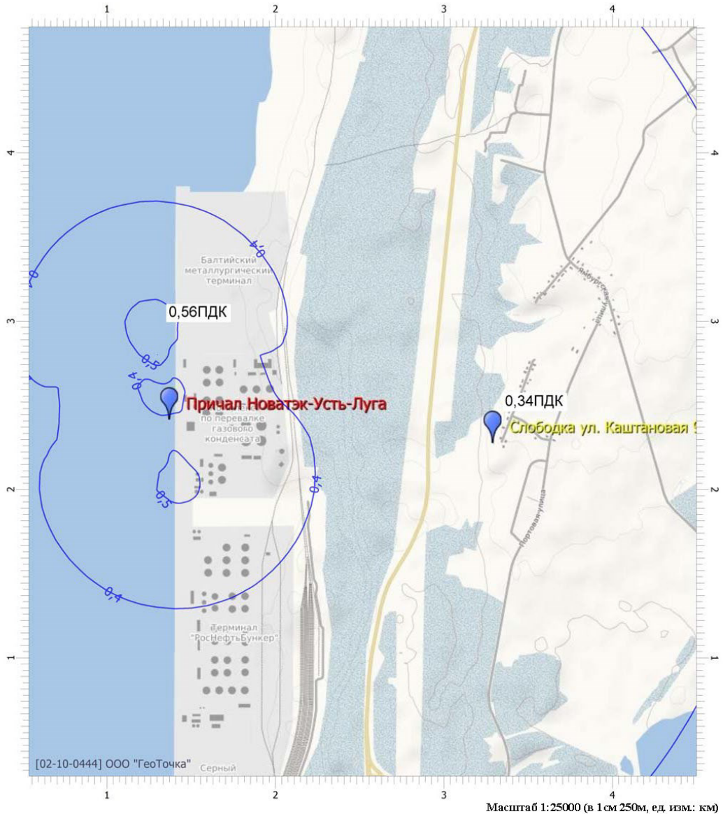
Рисунок 5.6. Схема концентраций при рассеивании диоксида азота в атмосфере в ситуации бункеровки на акватории на акватории порта Усть-Луга
