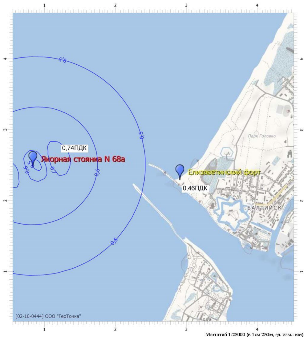
Рисунок 5.13. Схема концентраций при рассеивании диоксида азота в атмосфере в ситуации бункеровки на рейде порта Балтийск
