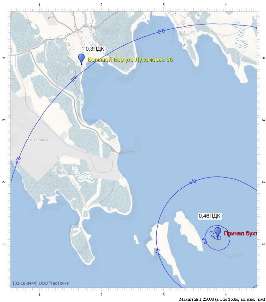
Рисунок 5.2. Схема концентраций при рассеивании диоксида азота в атмосфере в ситуации погрузки СПГ на акватории порта Высоцк бухта Дальняя
