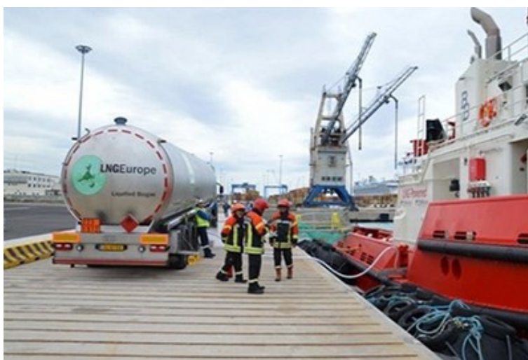
Рисунок 2.25. Бункеровка СПГ при помощи топливозаправщика (TTS)
