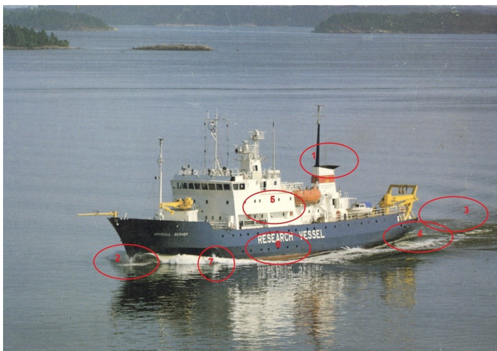
Рисунок 13.1. Основные источники воздушного шума судна
