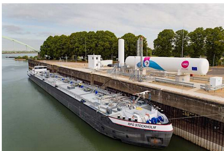
Рисунок 2.27. Бункеровка СПГ с берегового терминала
