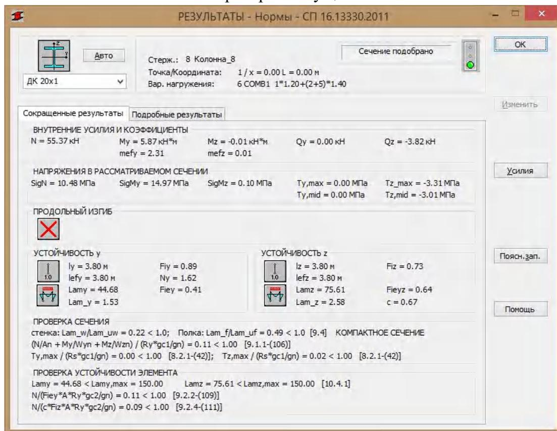
Рис. 52 Проверка несущей способности основных колонн
