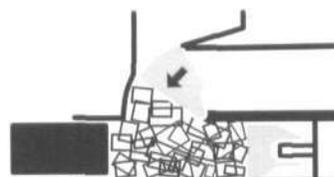
Предварительный пресс опускается и сжимает материал в пресс-камеру
