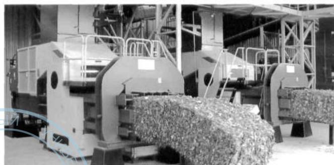
из вторсырья высококачественное топливо для электростанций (т. н. RDF - residue derived fuel). Материал, предназначенный для сжигания и производства энергии, нужно прессовать в кипы для более удобного складирования и транспортировки.
