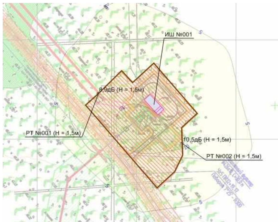
Рисунок 2.2 – Схема расположения расчетных точек и источников шума
