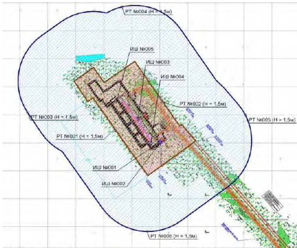
Рисунок 2.2 – Схема расположения расчетных точек, границы санитарно-защитной зоны и источников шума куста скважин №863
