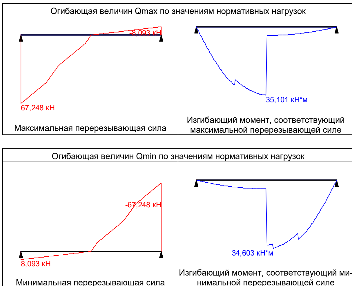
Рис. В.15 – Огибающая величин: Q_{max} , Q_{min} , M_{max} , M_{min} по значениям нормативных нагрузок
