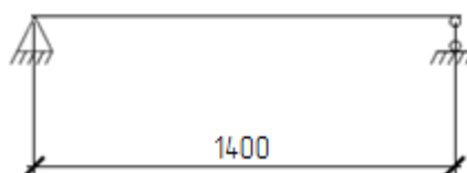
Рисунок 3 - Расчетная схема профилированного настила
