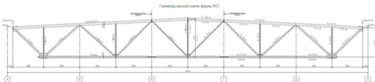
Рисунок 29 Схема фермы покрытия
