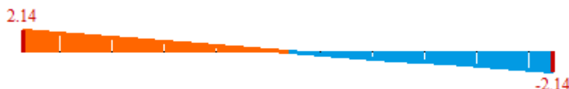
Рисунок 7 - Эпюра поперечной силы при действии расчетной комбинации нагрузок, кН
