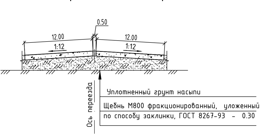
Сечение переезда по оси проезда
