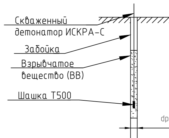
Конструкция скважинного заряда Масштаб 1:200
