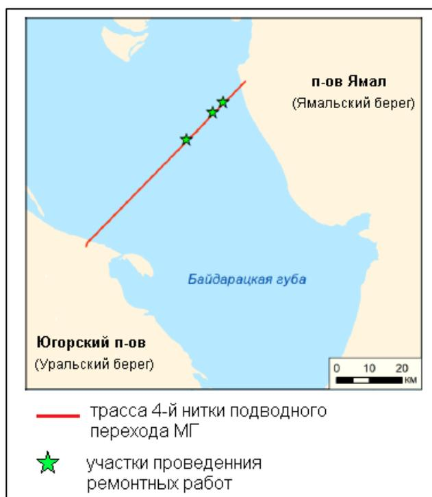
**Рисунок 1.3.1 – Схема расположения трассы четвертой нитки подводного перехода магистрального газопровода «Бованенково-Ухта» через Байдарацкую губу (из материалов инженерных изысканий, переданных ООО «Газпром трансгаз Ухта» в рамках договора № 0441.051.001.2019/2 от 26.12.2019 г.)**
