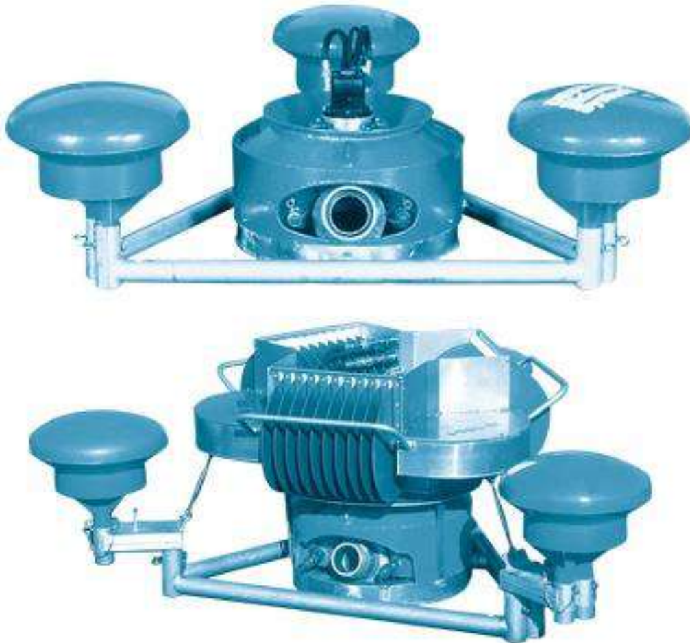
Рис. 6. Внешний вид нефтесборной системы с присоединяемым оборудованием (вверху – скиммер без приставки, внизу – скиммер с подключённой приставкой)
