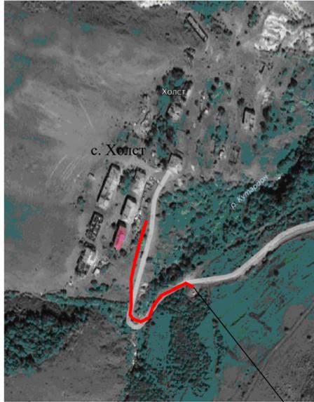
Врезка стального участка Ø57x3,5 проектируемого газопровода низкого давления P≤0,005 МПа Ø63x5,8 к существующему стальному газопроводу Ø89
