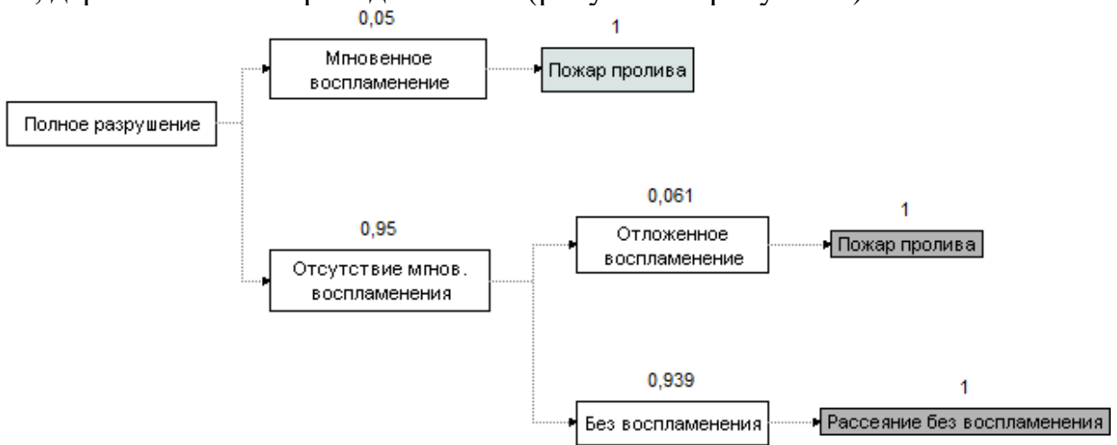
Рисунок 5 - Дерево событий для емкостного оборудования, содержащего дизельное топливо или моторное масло на складе ГСМ
