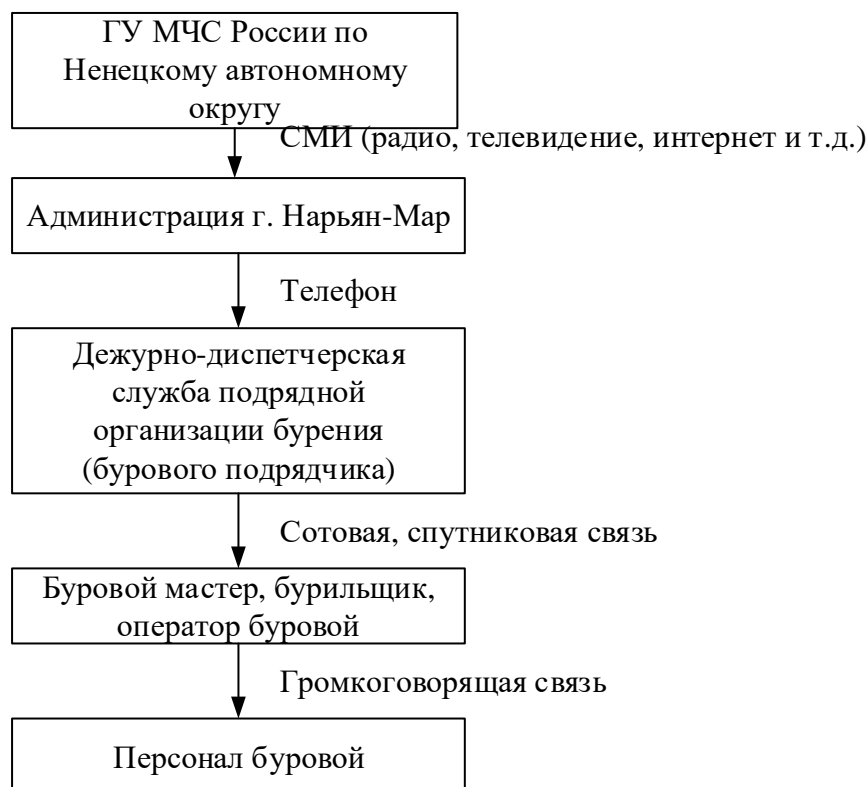
Рисунок 1 - Схема оповещения производственного персонала по сигналам гражданской обороны
