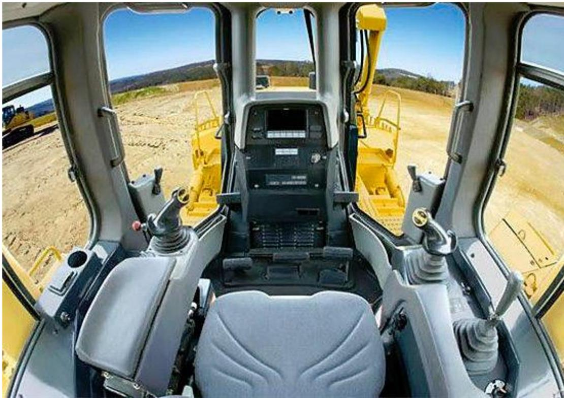
Рисунок 10.1 – Рабочее место оператора бульдозера
