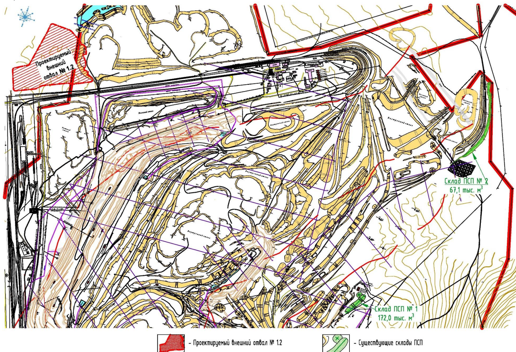
Рисунок 3.1 – Схема расположения складов ПСП на АО «Разрез Харанорский» по состоянию на 01.01.2022 г.
