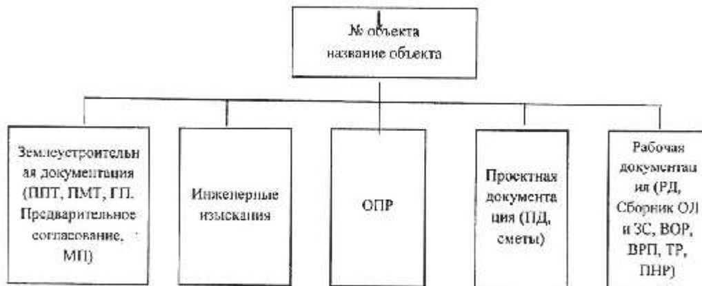
Рис.1 Схема файловой системы проектной документации на электронном носителе
