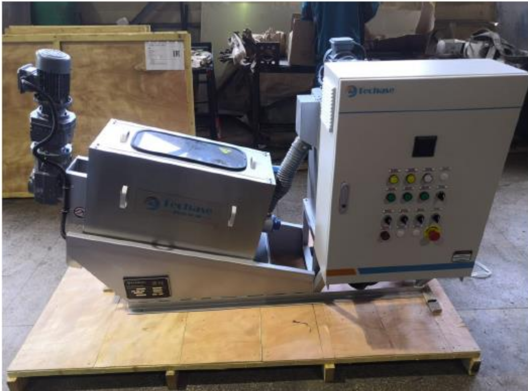
Рис.6 Установка обезвоживания осадка
