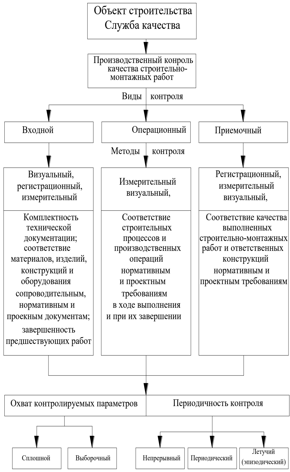
Рисунок 1 - Схема производственного контроля качества строительно-монтажных работ
