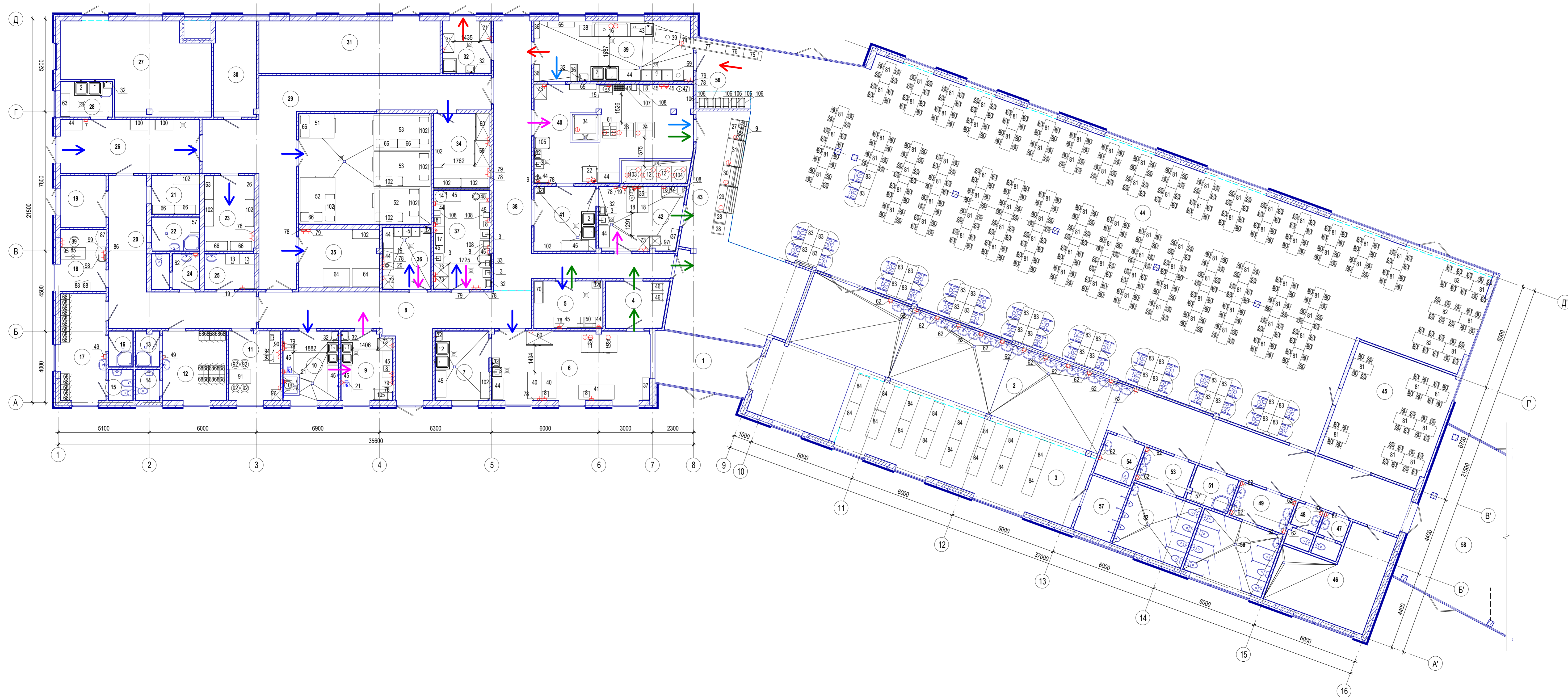
План 1 этажа с расстановкой технологического оборудования
