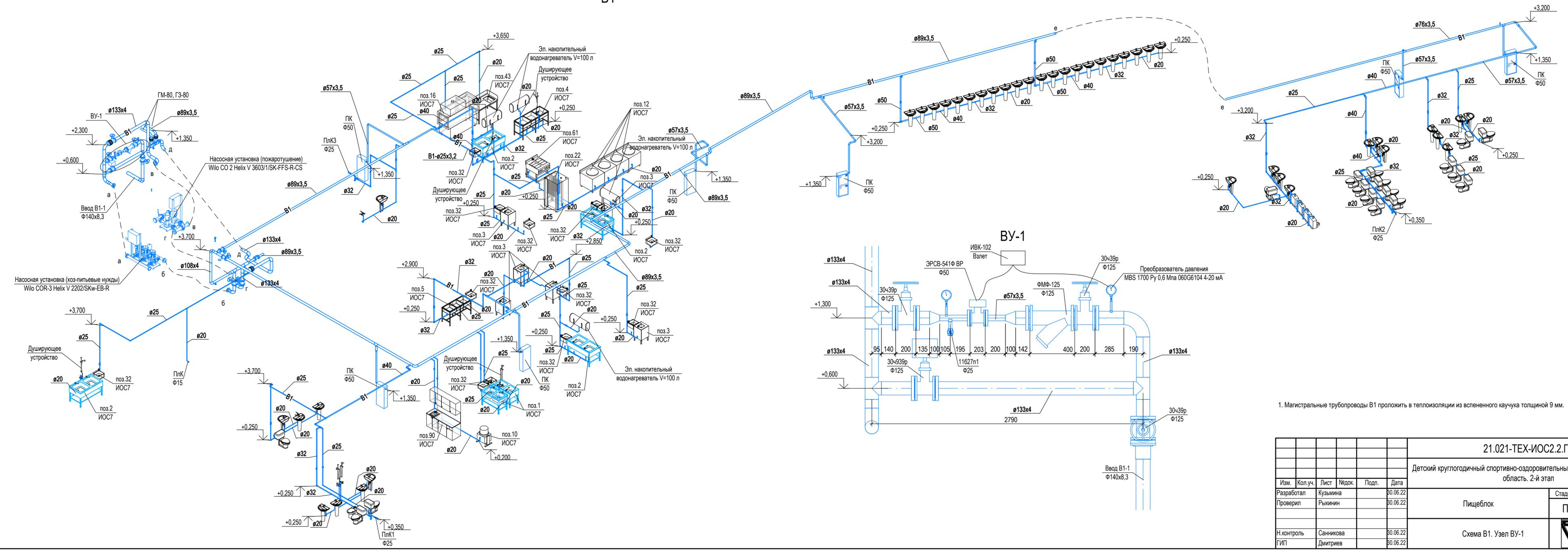
1. Магистральные трубопроводы В1 проложить в теплоизоляции из вспененного каучука толщиной 9 мм.
