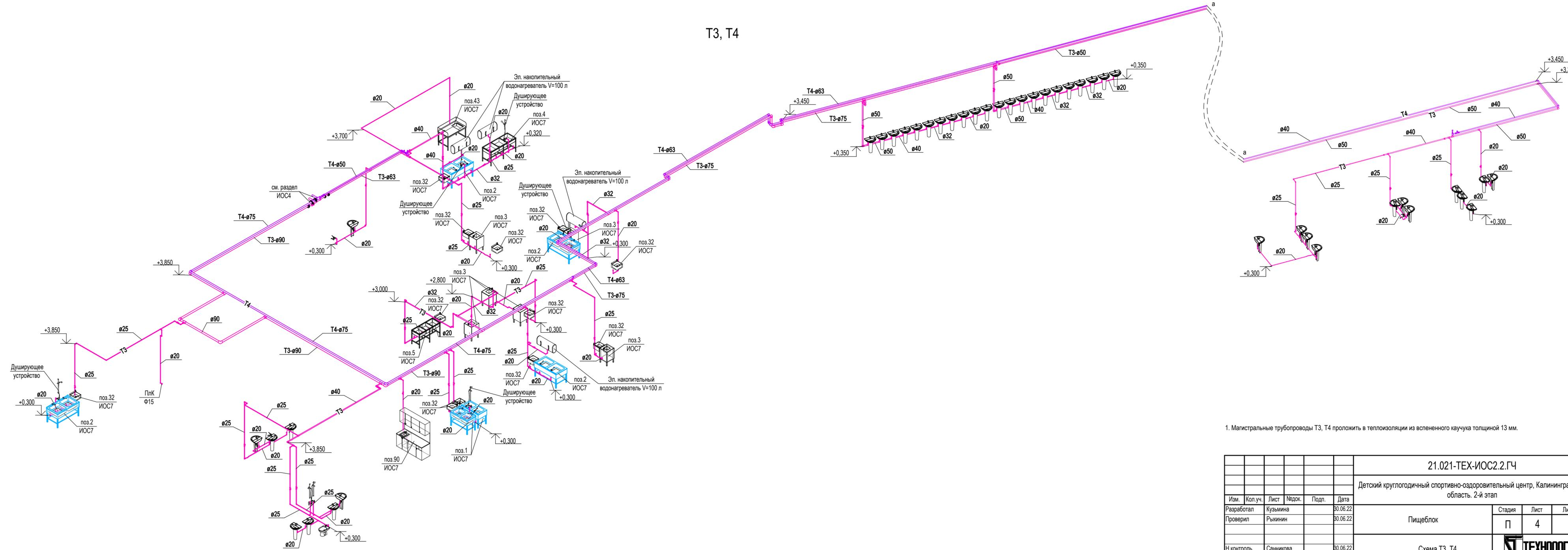
1. Магистральные трубопроводы T3, T4 проложить в теплоизоляции из вспененного каучука толщиной 13 мм.
