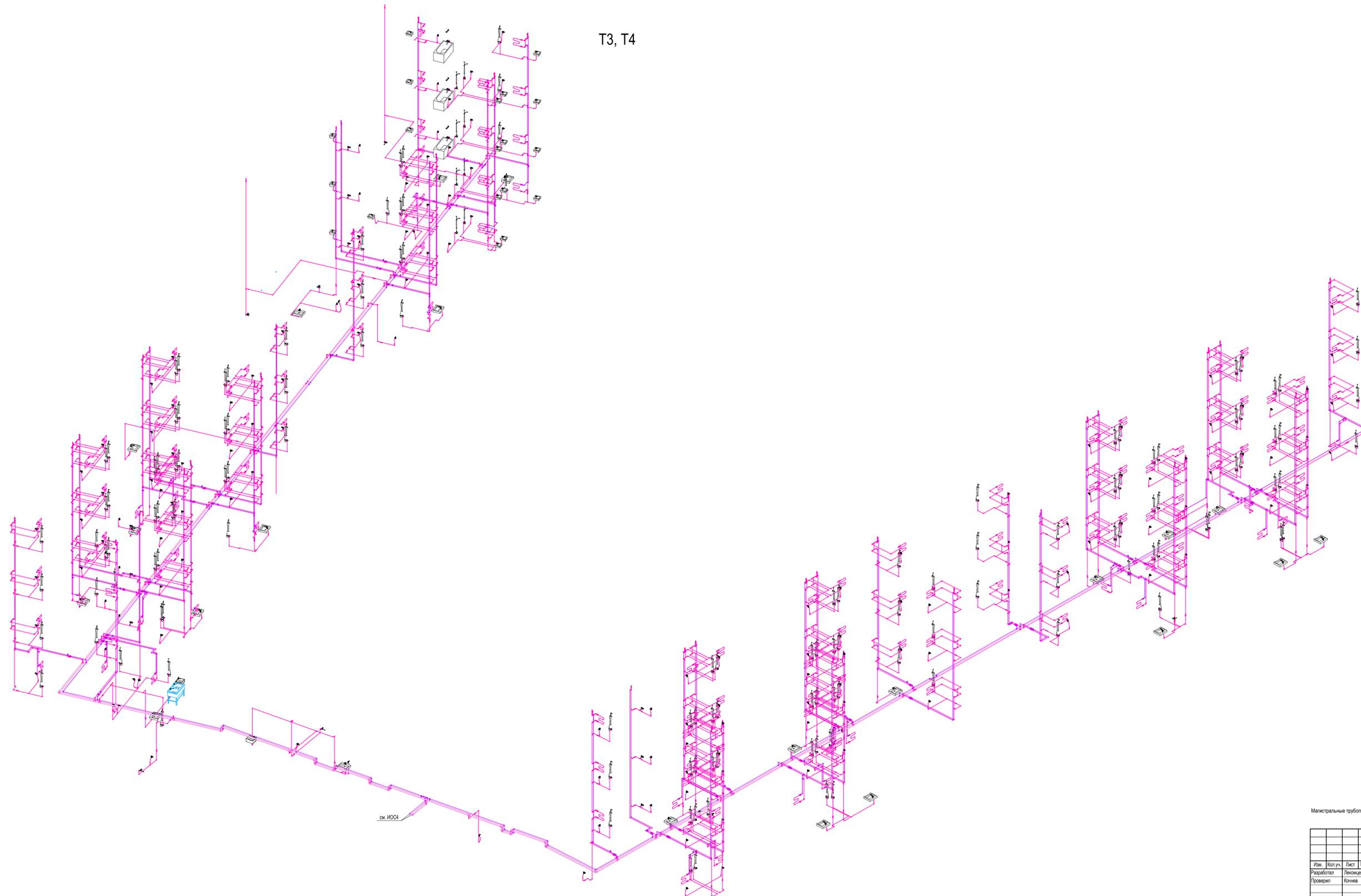
Магистральные трубопроводы и стояки проложить в теплоизоляции из вспененного каучука толщиной 13 мм
