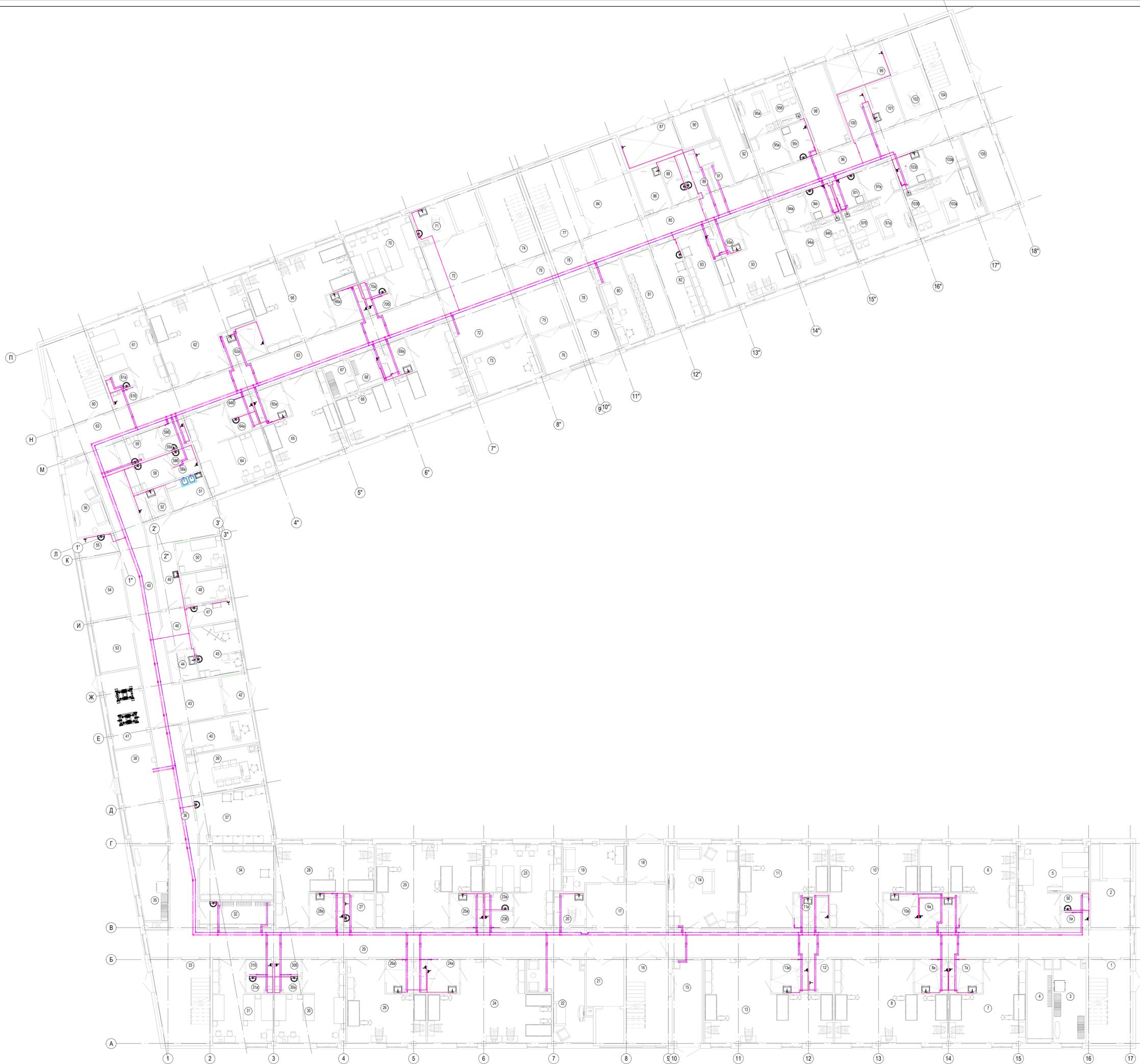
Магистральные трубопроводы и стояки проложить в теплоизоляции из вспененного каучука толщиной 13 мм
