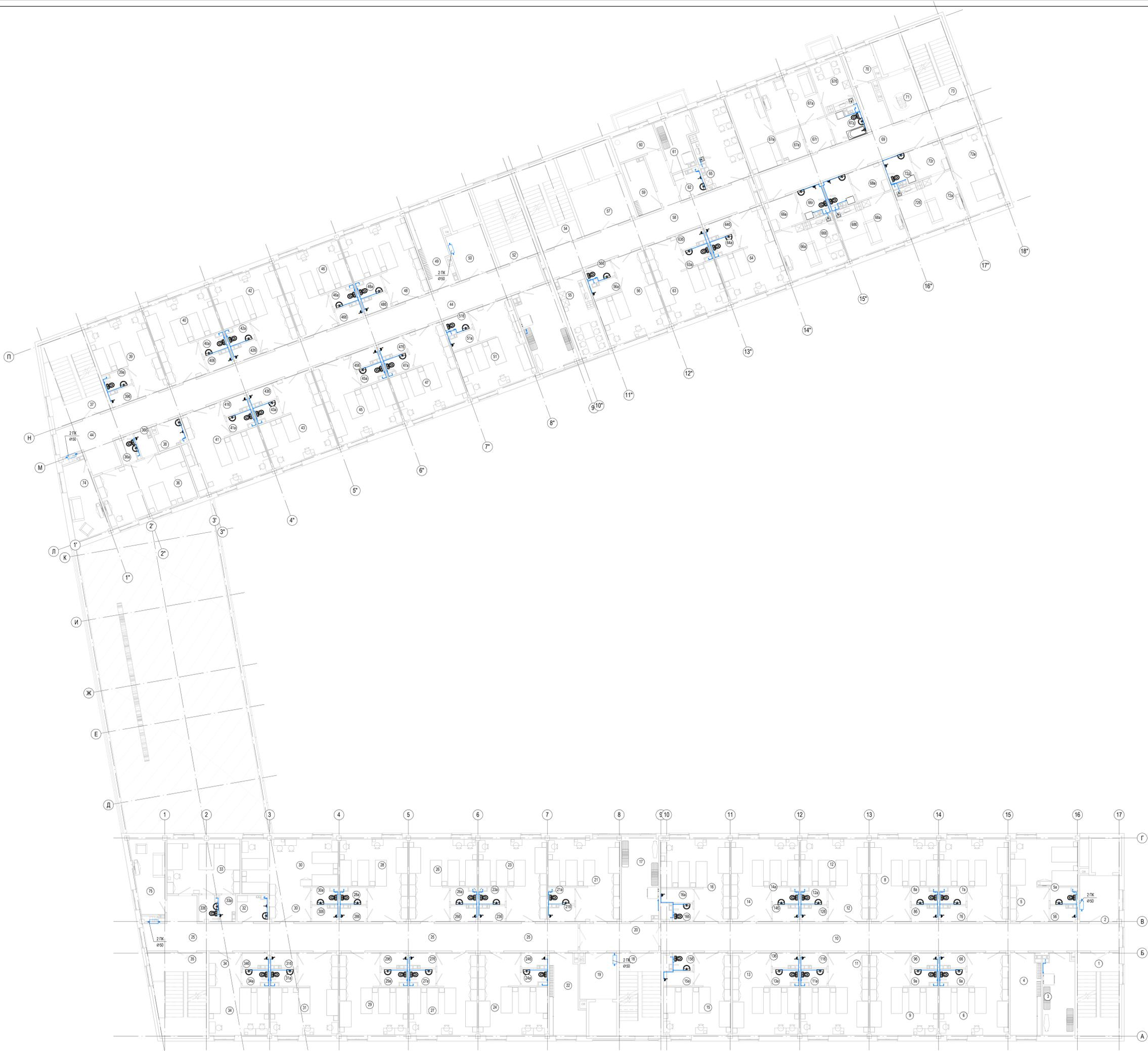
Магистральные трубопроводы и стояки проложить в теплоизоляции из вспененного каучука толщиной 9 мм
