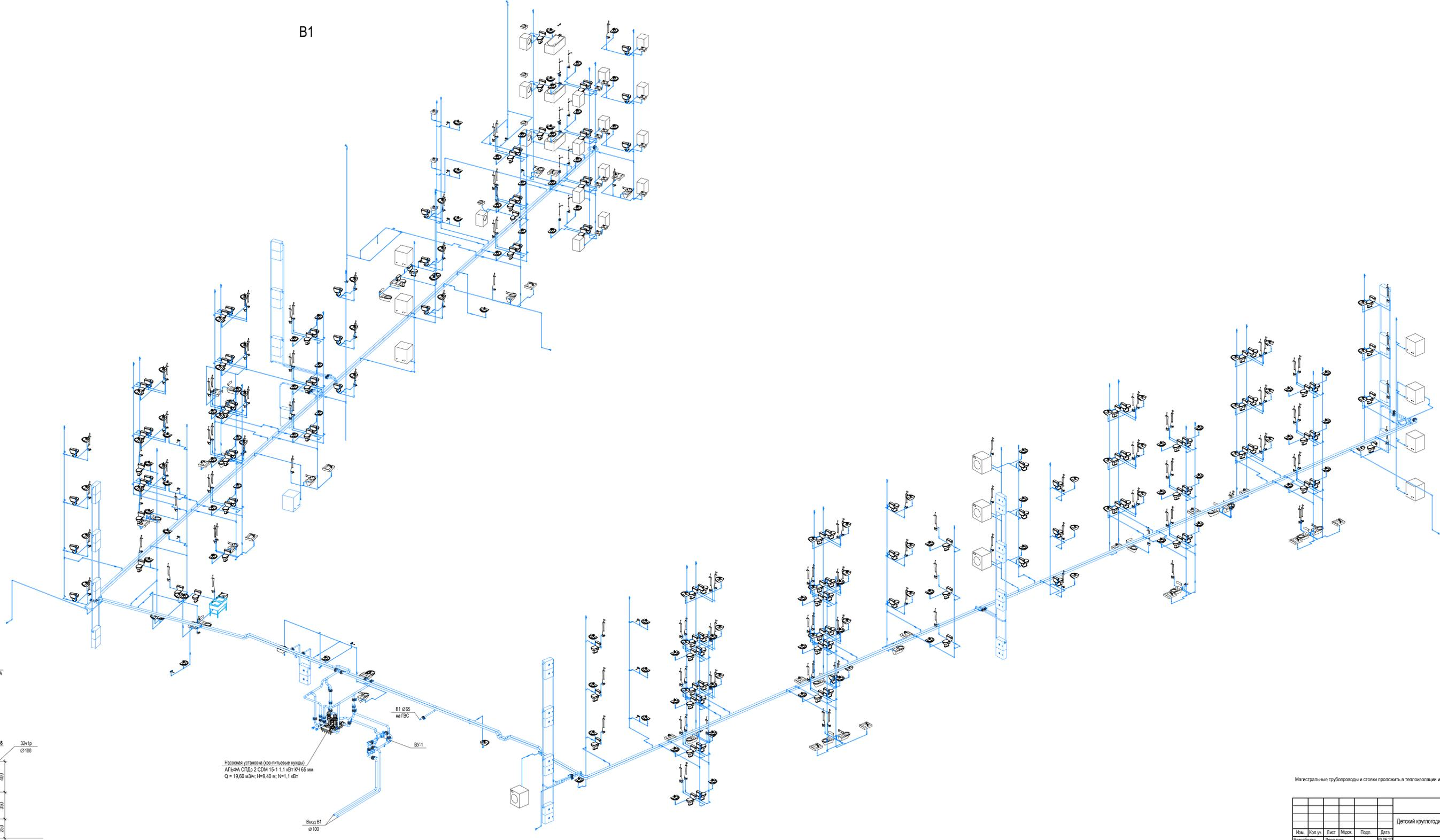
Магистральные трубопроводы и стояки проложить в теплоизоляции из вспененного каучука толщиной 9 мм
