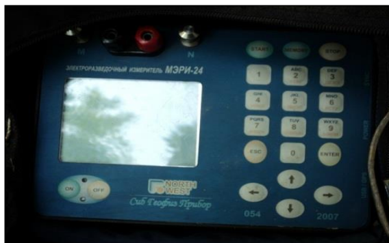
Рисунок 12.2 — Электроразведочный измеритель «МЭРИ-24»
