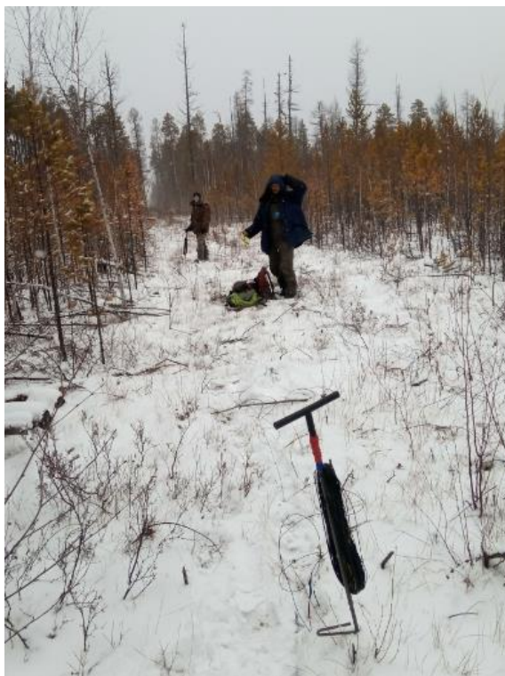
Рисунок 12.4 — Фотография полевых измерений методом ВЭЗ
