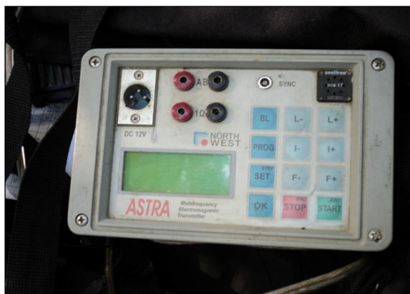
Рисунок 12.1 — Электроразведочный генератор «Астра»
