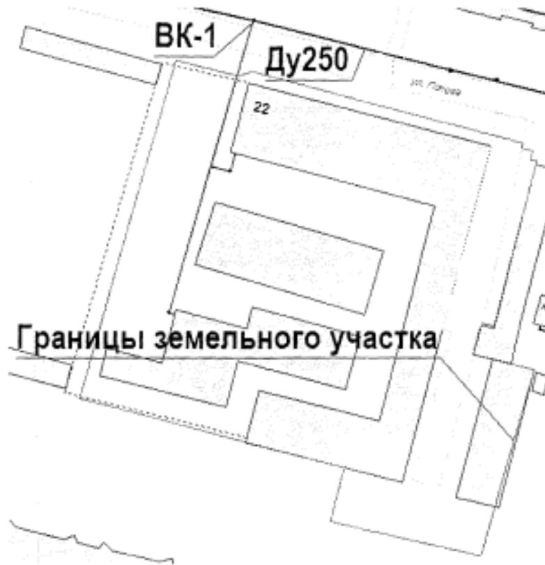
ВК-1 — точка подключения объекта на существующем водопроводе Ду 250 мм / граница раздела балансовой принадлежности / граница эксплуатационной ответственности
