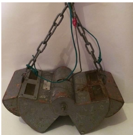
Рисунок 4.1 – Дночерпатель. Общий вид
