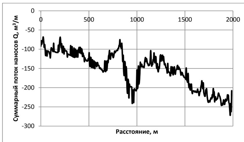
**Рисунок 2.11.1.3 - Суммарный поток наносов ( $Q$ , м<sup>3</sup>/м) за предполагаемое время ремонта трубопровода (из материалов инженерных изысканий, переданных ООО «Газпром трансгаз Ухта» в рамках договора № 0441.051.001.2019/2 от 26.12.2019 г.)**
