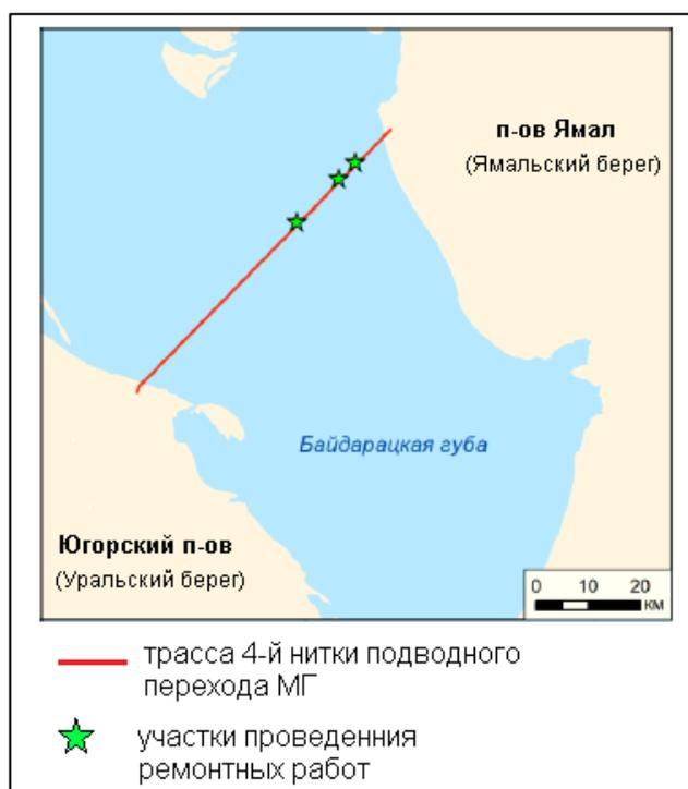
**Рисунок 2.1.1 – Схема расположения трассы четвертой нитки подводного перехода магистрального газопровода «Бованенково-Ухта» через Байдарацкую губу (из материалов инженерных изысканий, переданных ООО «Газпром трансгаз Ухта» в рамках договора № 0441.051.001.2019/2 от 26.12.2019 г.)**
