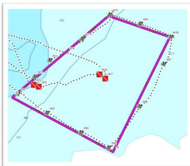
Рисунок 3-1: Треки эхолотных промеров, расположение водолазных разрезов и точек обследования дна с использованием телекамеры на участке № 35
