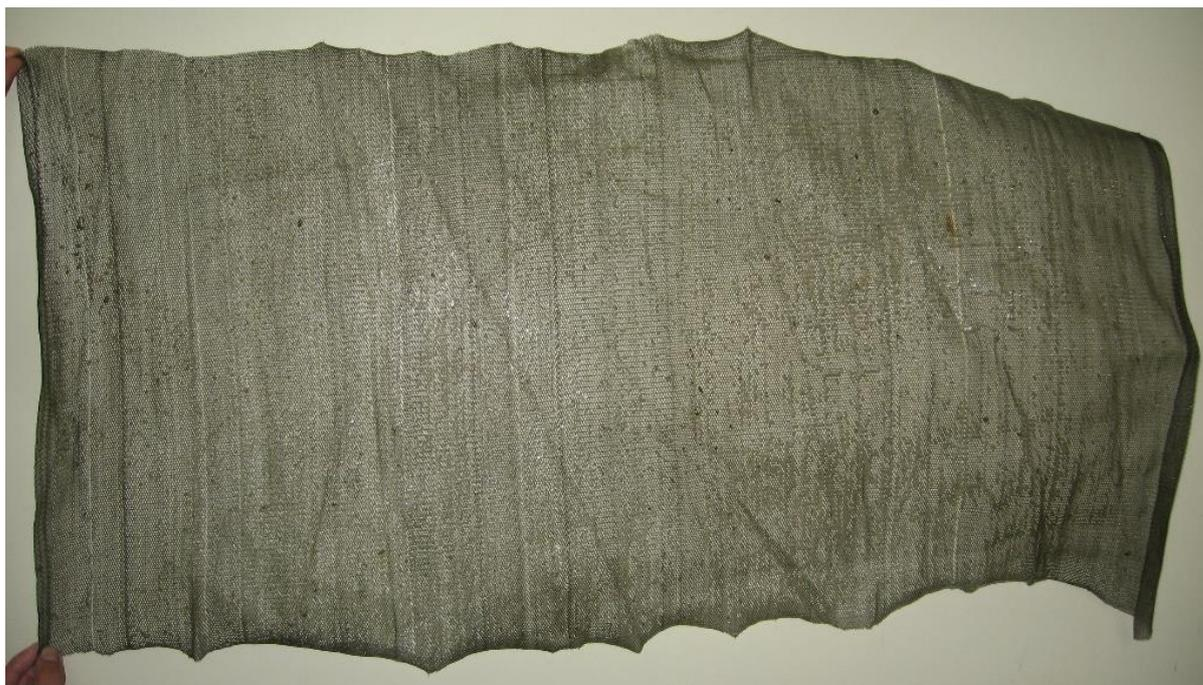
Рис.4.3-12: Мягкий субстрат – безузловая многонитчатая дель, изготовленная из капрона.
