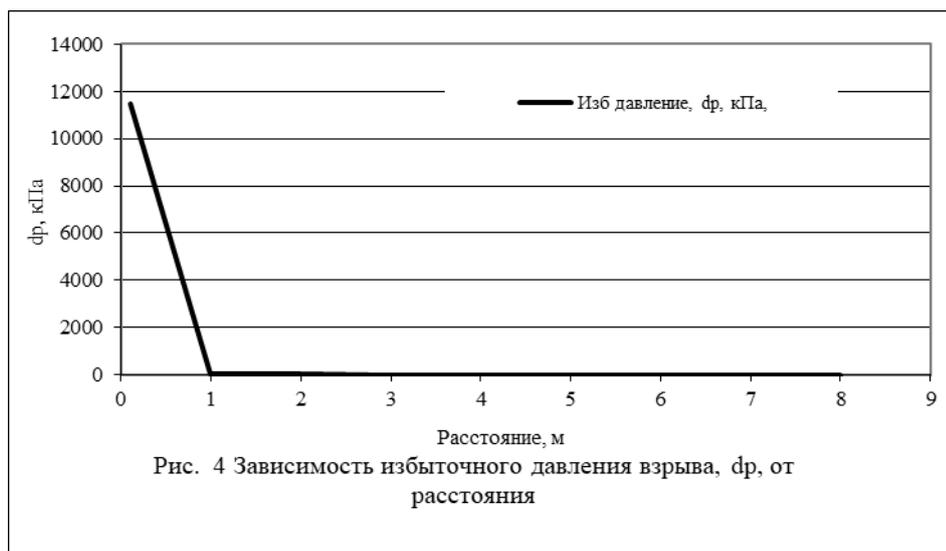
Рис. 4 Зависимость избыточного давления взрыва, дп, от расстояния
