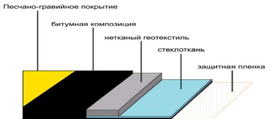
Рис. 5.3. Структура битумной геомембраны
