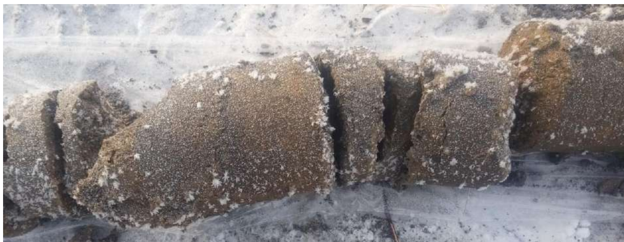
Рисунок 12 – Суглинок с включением гальки, гравия
