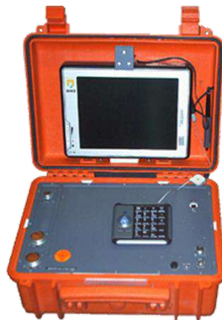
Рисунок 5 - Цифровая инженерная сеймостанция «Диоген-24/14»
