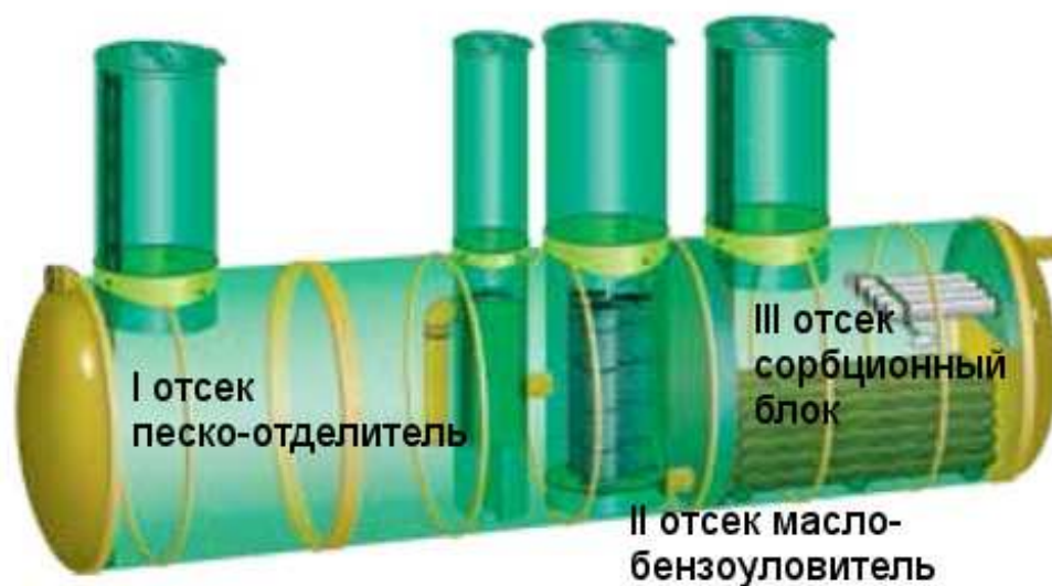
Рисунок 2.3 – Принципиальная схема сооружений глубокой очистки поверхностного стока
