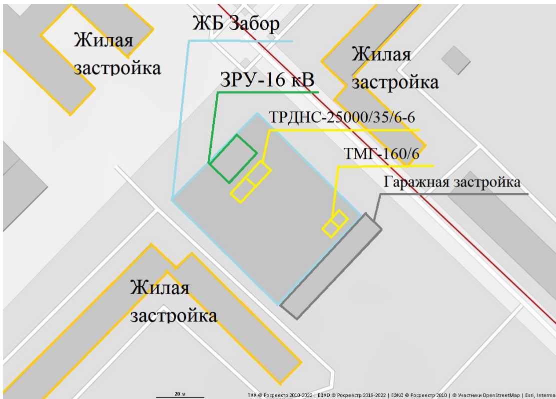
Рисунок 4.1 – Карта-схема расположения источников физического воздействия, экранов и жилой застройки на ПС 35 кВ РП-5
