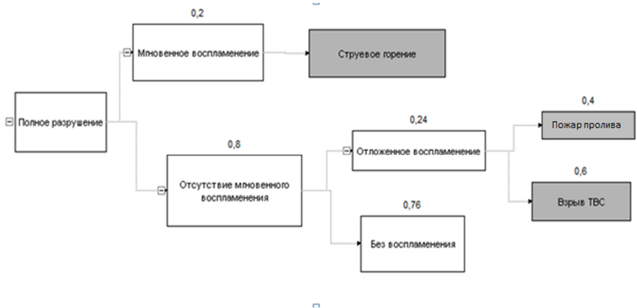
Рисунок 3 - Дерево событий для аварийной ситуации на трубопроводах
