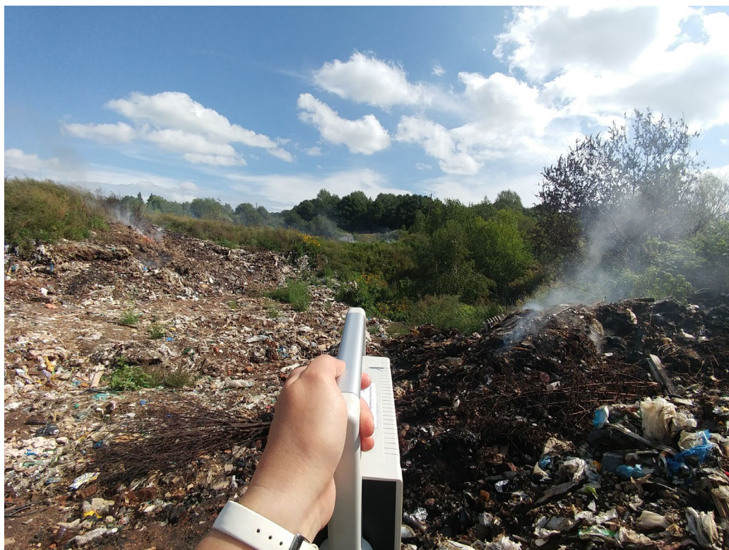
Фото 14. Измерение содержания ЗВ в атмосферном воздухе
