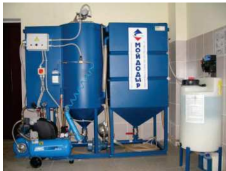
Установка «Мойдодыр М-КФ-2 (конструкционная сталь с антикор. покрытием)
