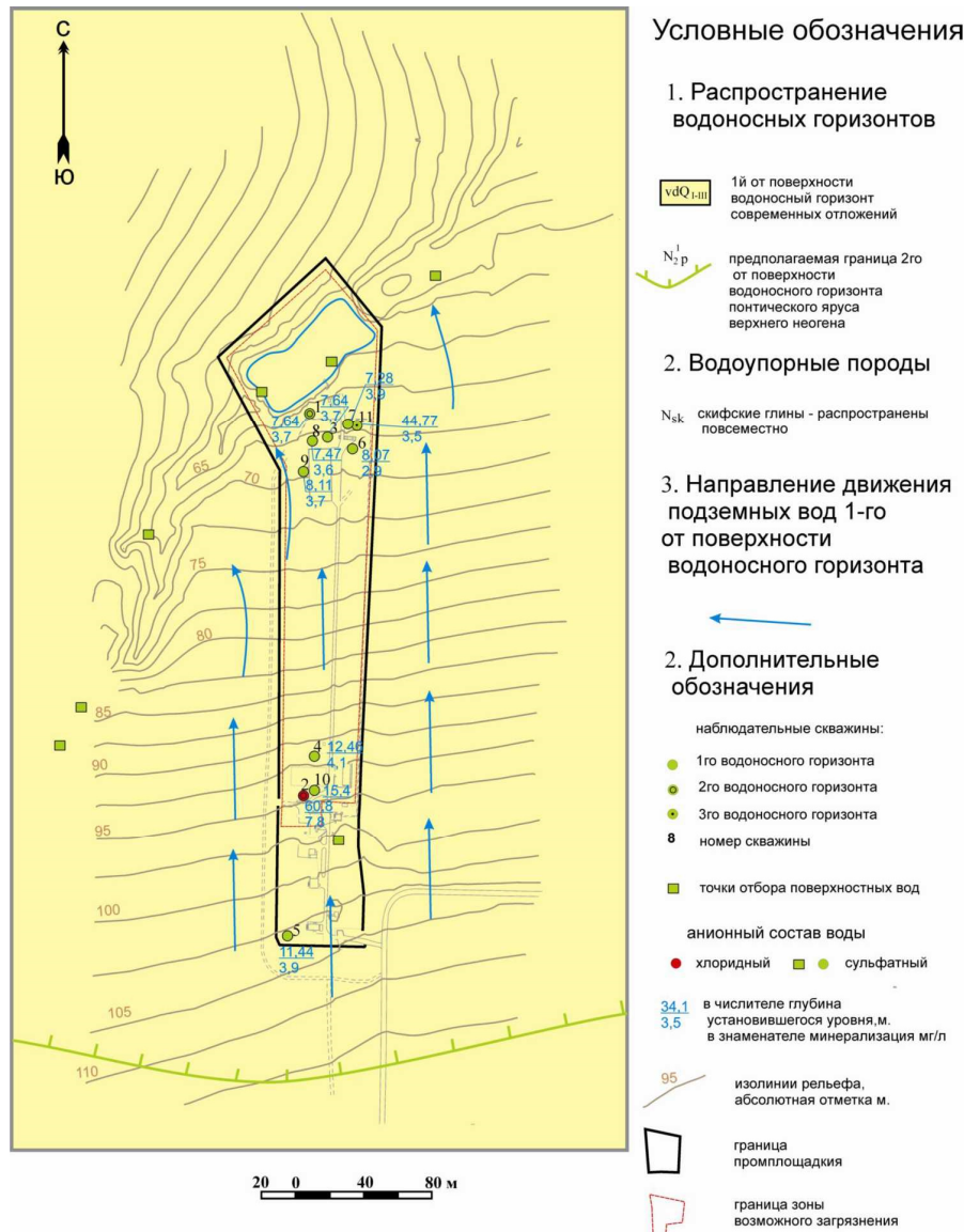
Рисунок 4.3.5.1 - Гидрогеологическая схема ПХРО филиала «Южный территориальный округ» ФГУП «ФЭО»
