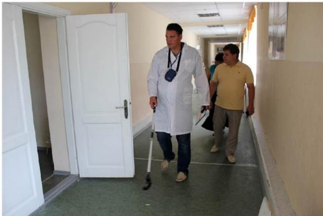
Рис. 7. Измерение МЭД в коридорах МОУ «Большосальская школа № 8».
