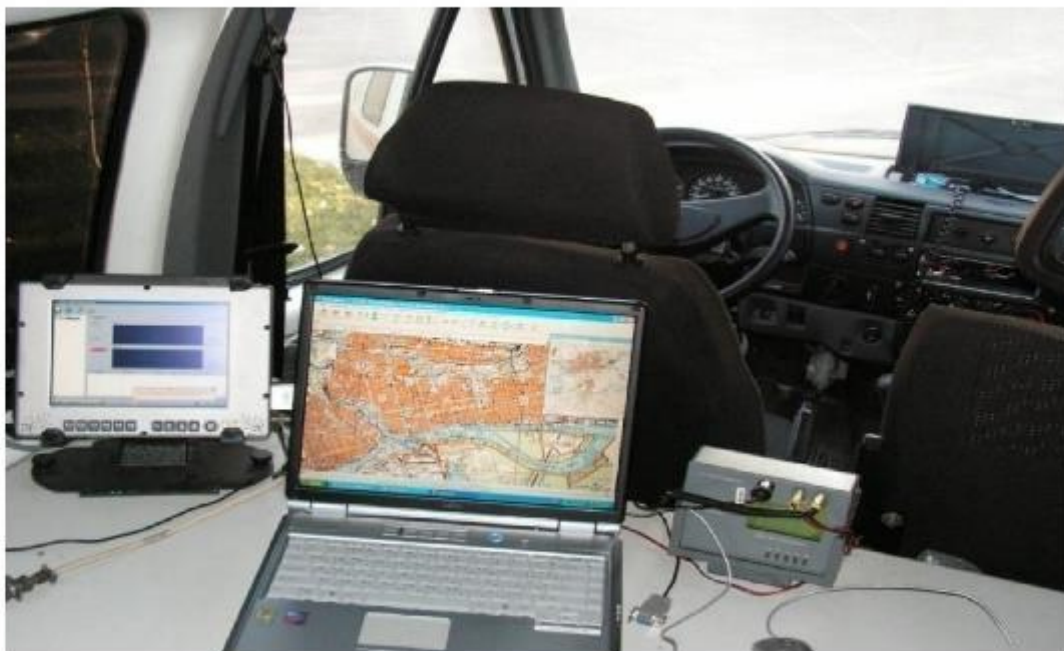
Рис. 3. Подготовка к проведению авто-гамма-съемки улиц села Большие Салты
