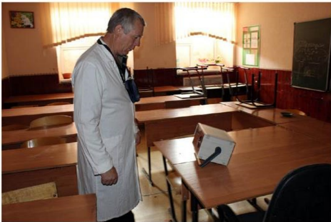
Рис. 5 Измерение радона-222 в кабинетах МОУ «Большесельская школа № 8»
