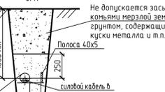
Соединение вертикальных заземлителей и стальной полосы выполнять согласно типового проекта А10-93-31 электросваркой. Сварку производить электродами типа ЭАЭ ГОСТ 9467-75\*. Места сварки покрыть битумным лаком
