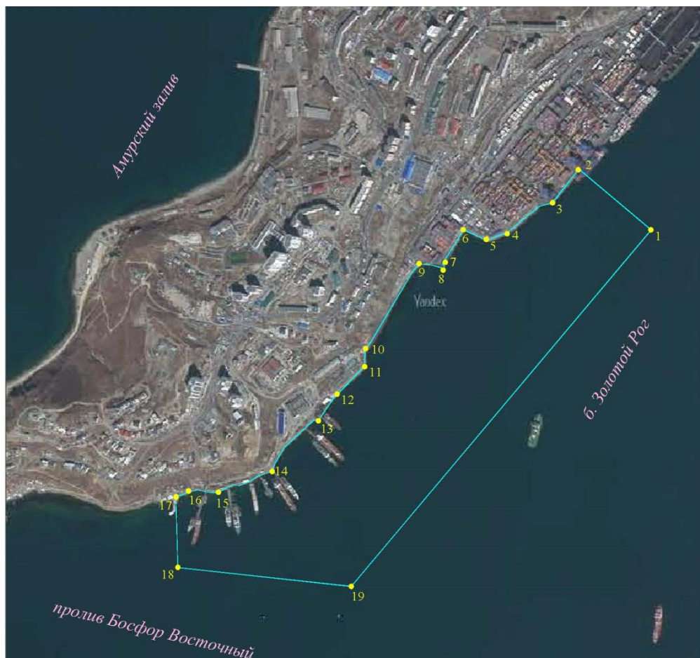
– Рис. 1.1 Схема границ участка комплексных инженерных изысканий с участком ведения буровых работ.
