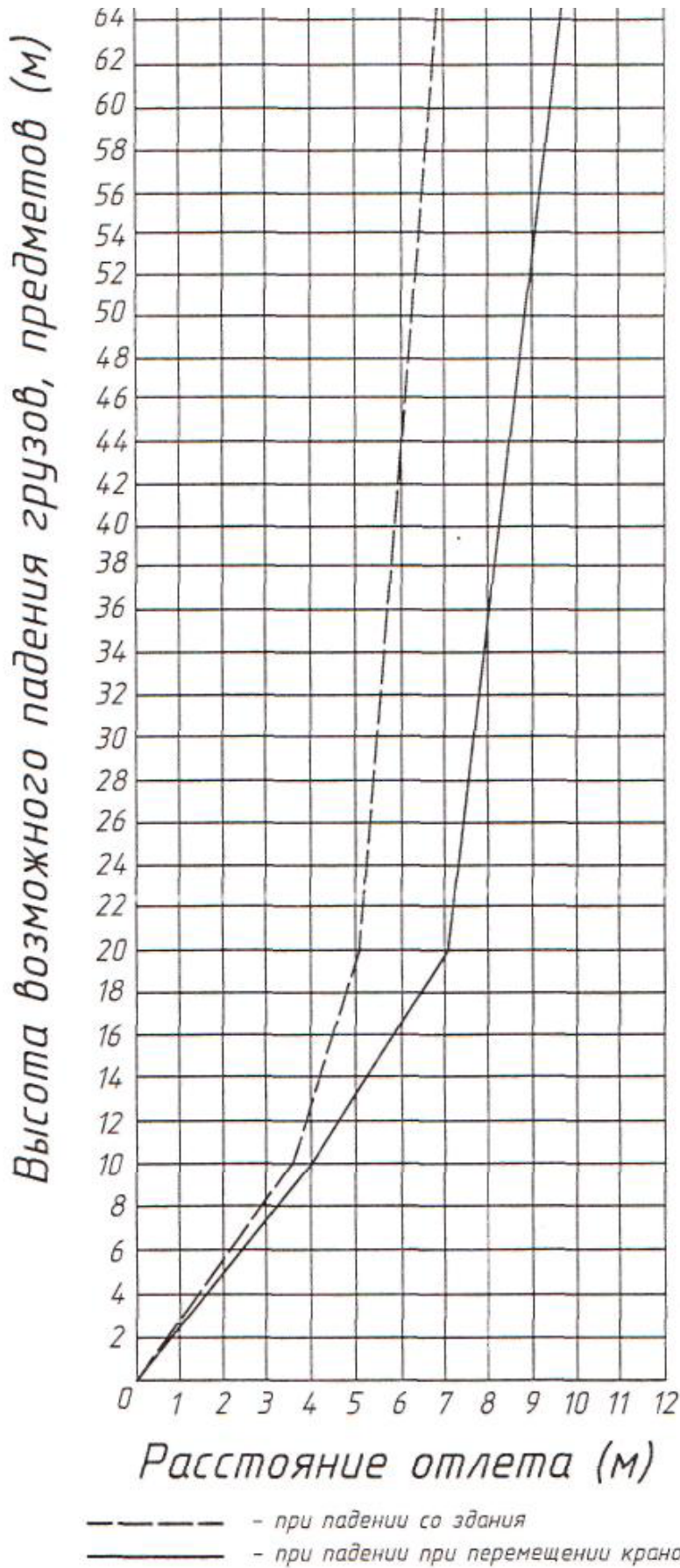
Рис. 12.1 – Минимальное расстояние отлета груза (предмета).
