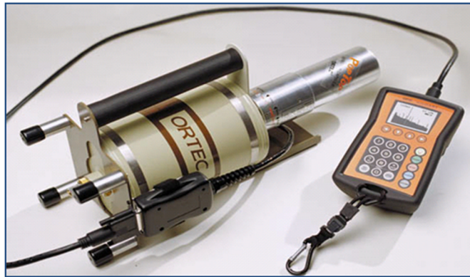
Рисунок 9.2 – Спектрометр - радиометр цифровой портативный многоканальный гамма и рентгеновского излучения digiDART
