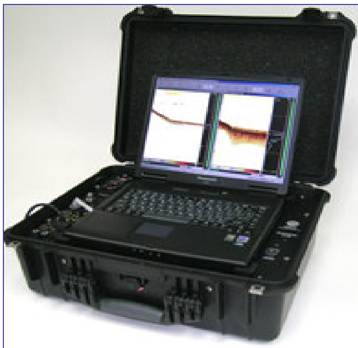
Техническая характеристика эхолота ECHOTRAC™ SVM
