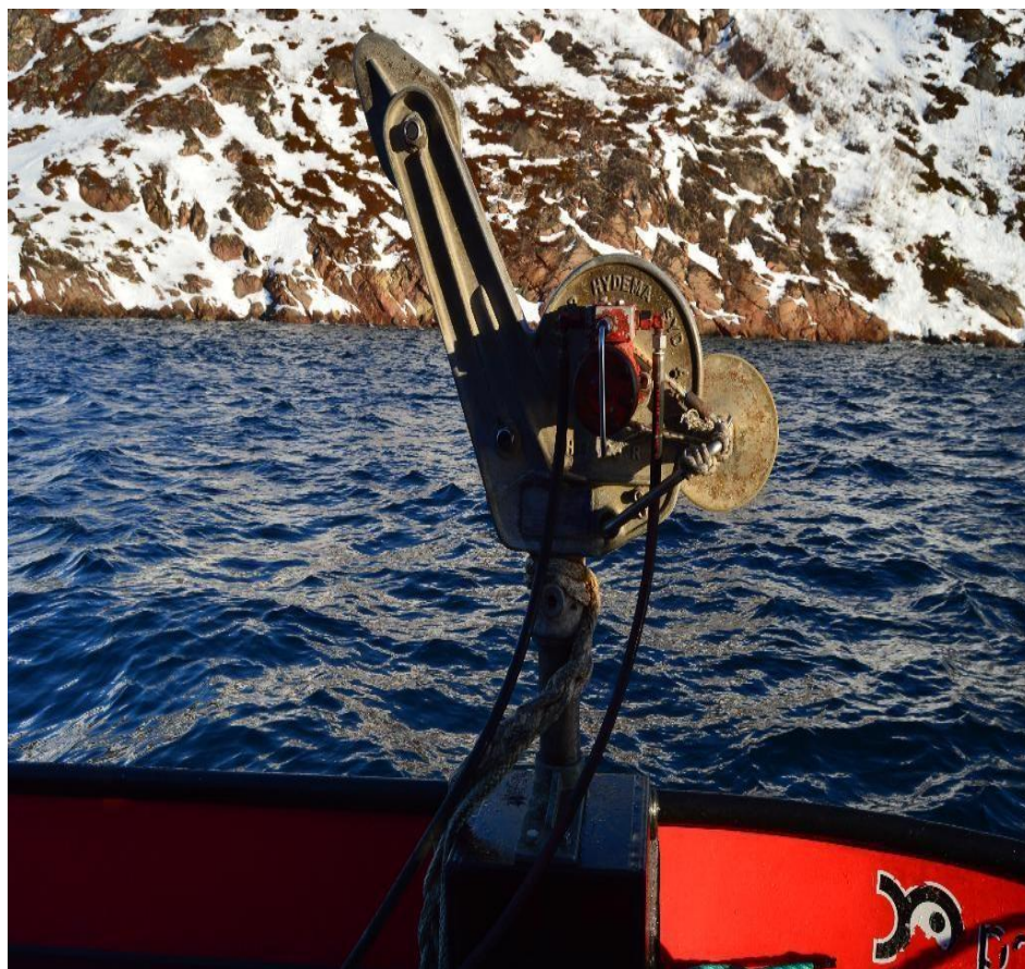
Рисунок 1.15 - Лебедка, установленная на рабочей лодке рыбоводов
