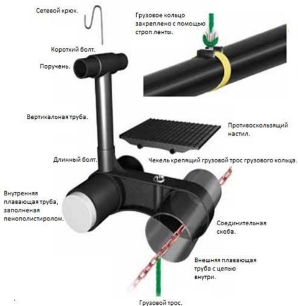
Рисунок 1.9 – Конструкция садка в разрезе
