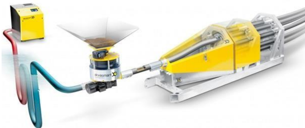
Рисунок 1.7 - Слева направо: компрессор, дозатор, селектор, кормовые трубы
