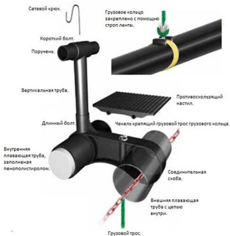
Рисунок 2.9 – Конструкция садка в разрезе
