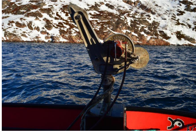
Рисунок 2.17 – Лебедка, установленная на рабочей лодке рыбоводов
