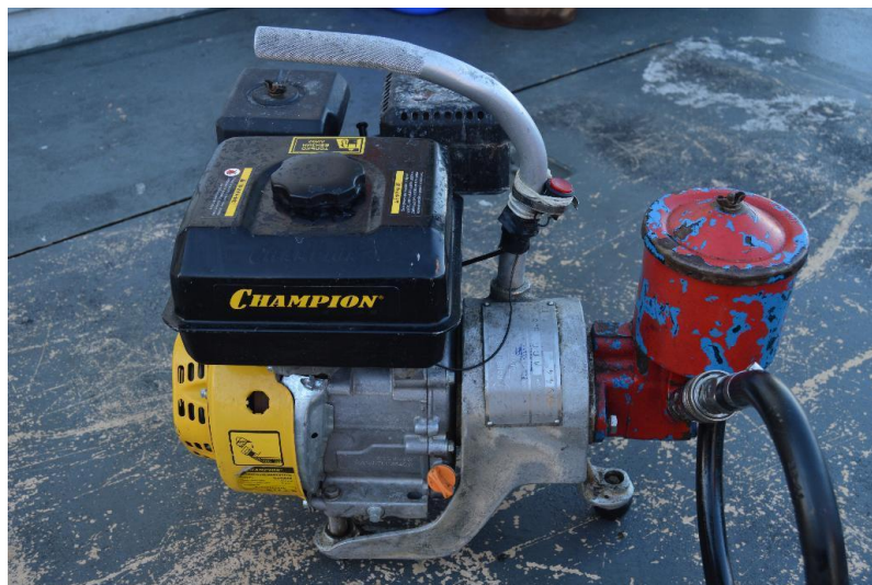
Рисунок 2.18 – Силовой агрегат (двигатель и насос) лебедки
