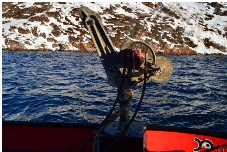
Рисунок 2.17 – Лебедка, установленная на рабочей лодке рыбоводов
