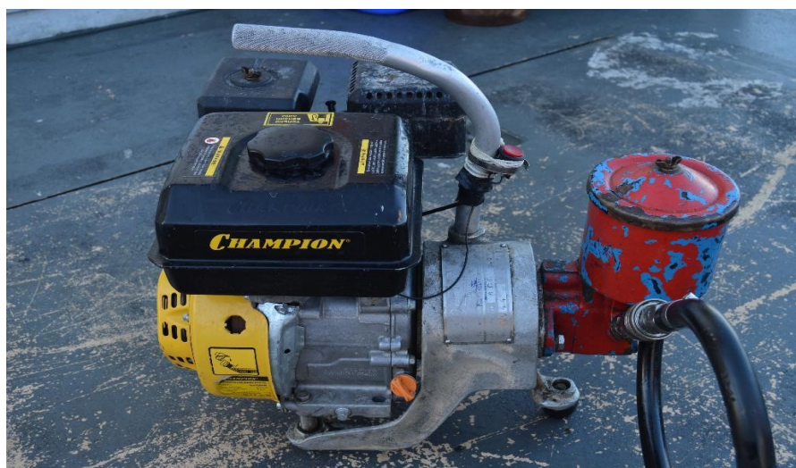
Рисунок 1.18 – Силовой агрегат (двигатель и насос) лебедки
