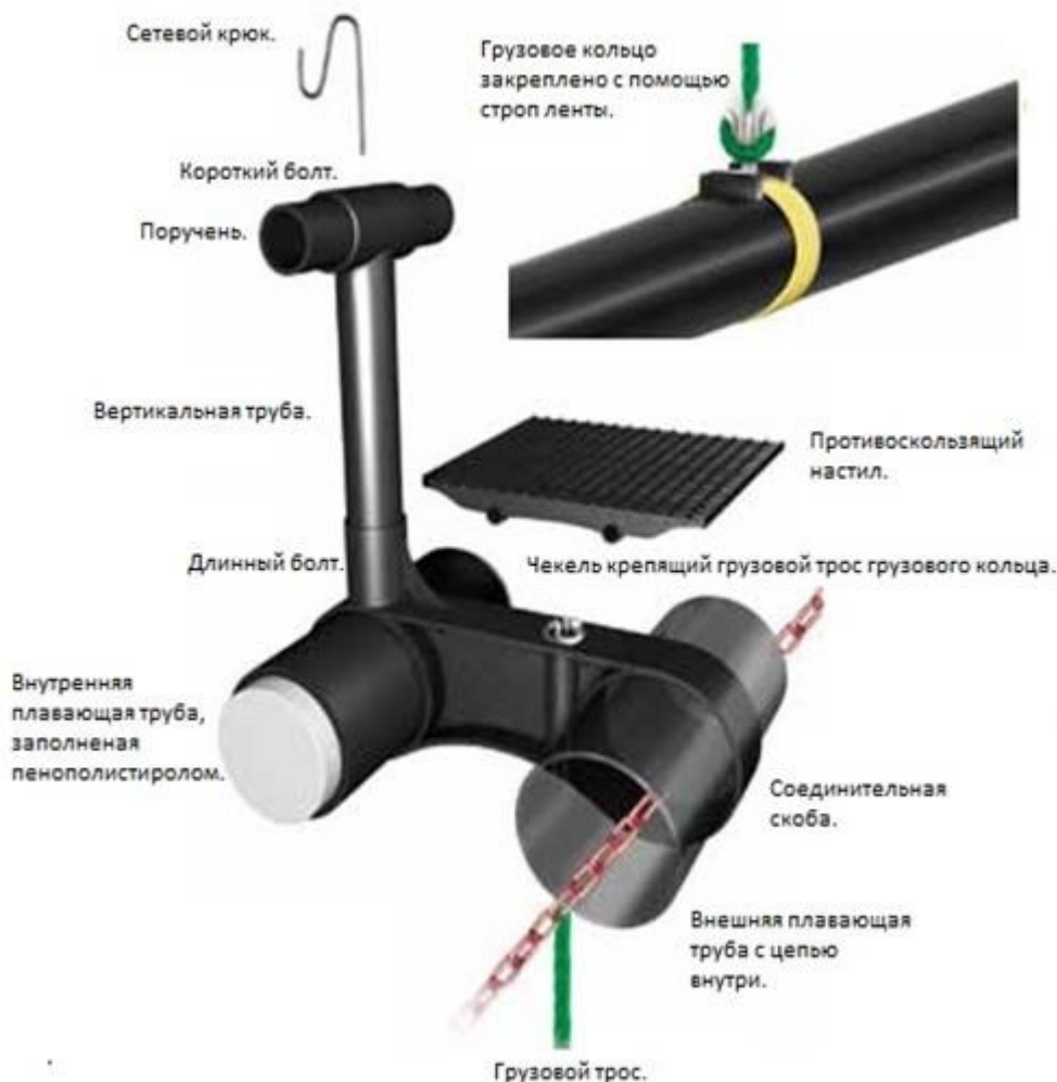
Рисунок 1.10 – Конструкция садка в разрезе
