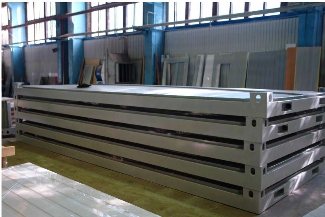
*Рис. 4. Транспортный пакет панелей покрытия*
