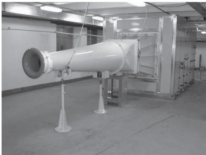
СТЕНД для аэродинамических испытаний типа «А» в ЦИЛ ООО «ВЕЗА»
