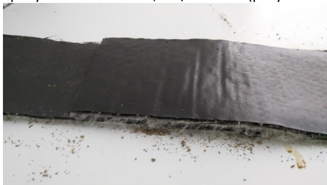
Рисунок 16 – Выполнение герметизации нахлеста по способу №1
