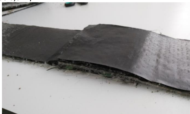
Рисунок 17 – Выполнение герметизации нахлеста по способу №2
