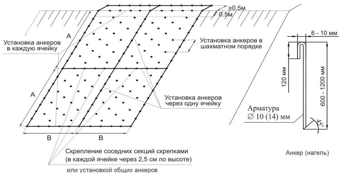
Рисунок 22 – Схема крепления объемной георешетки анкерами и размеры анкера
