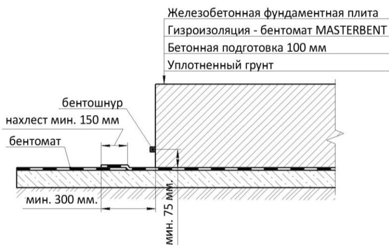
Рисунок 28 – Устройство изоляции непосредственно в опалубке с последующим бетонированием конструкции: А) Схема укладки бентонитовых матов Б) Фото уложенного бентонитового мата MASTERBENT на объекте Espoo Финляндия, подземный паркинг Suvinitty
