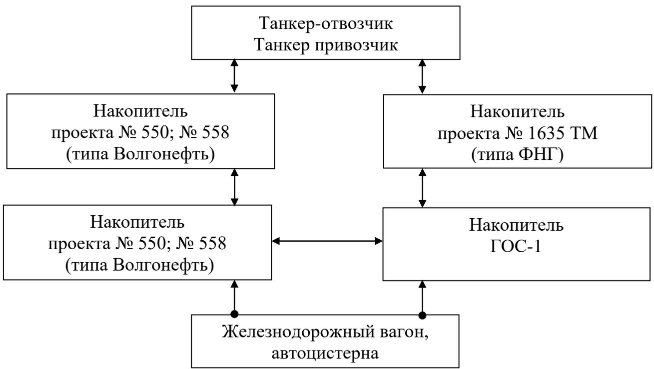
Рисунок 3.1 - Схема перегрузки на причале СВ-16М.
