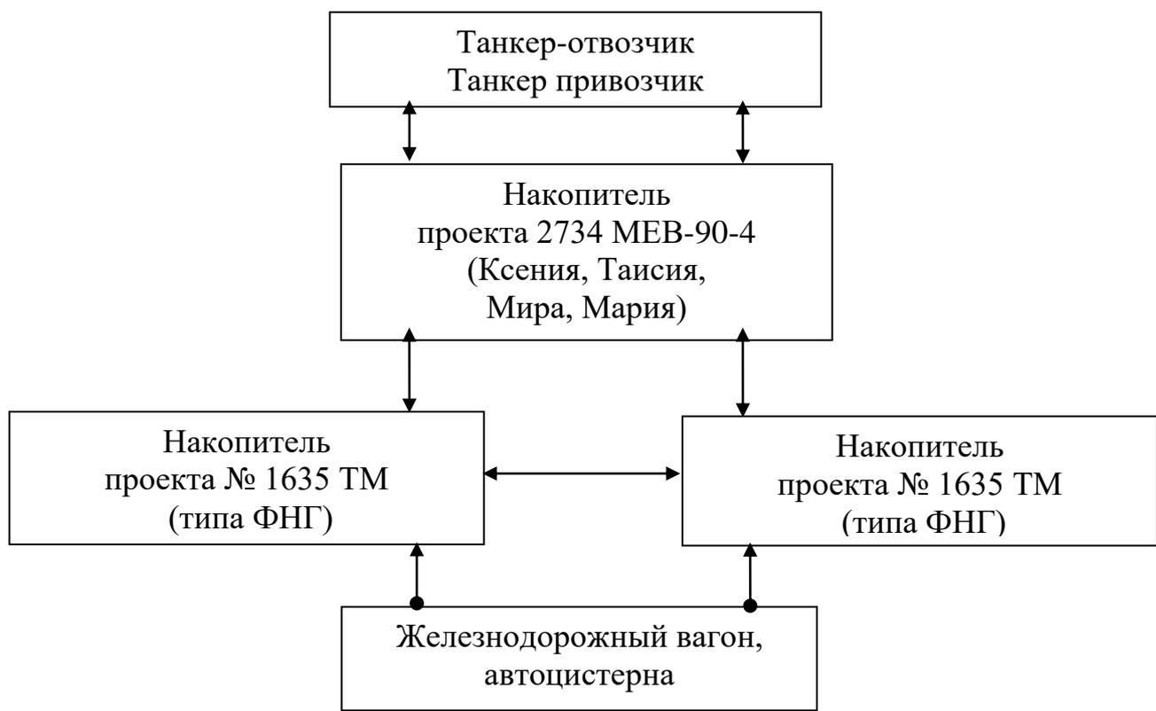
**Рисунок 3.2 - Схема перегрузки на причале СВ-15**
