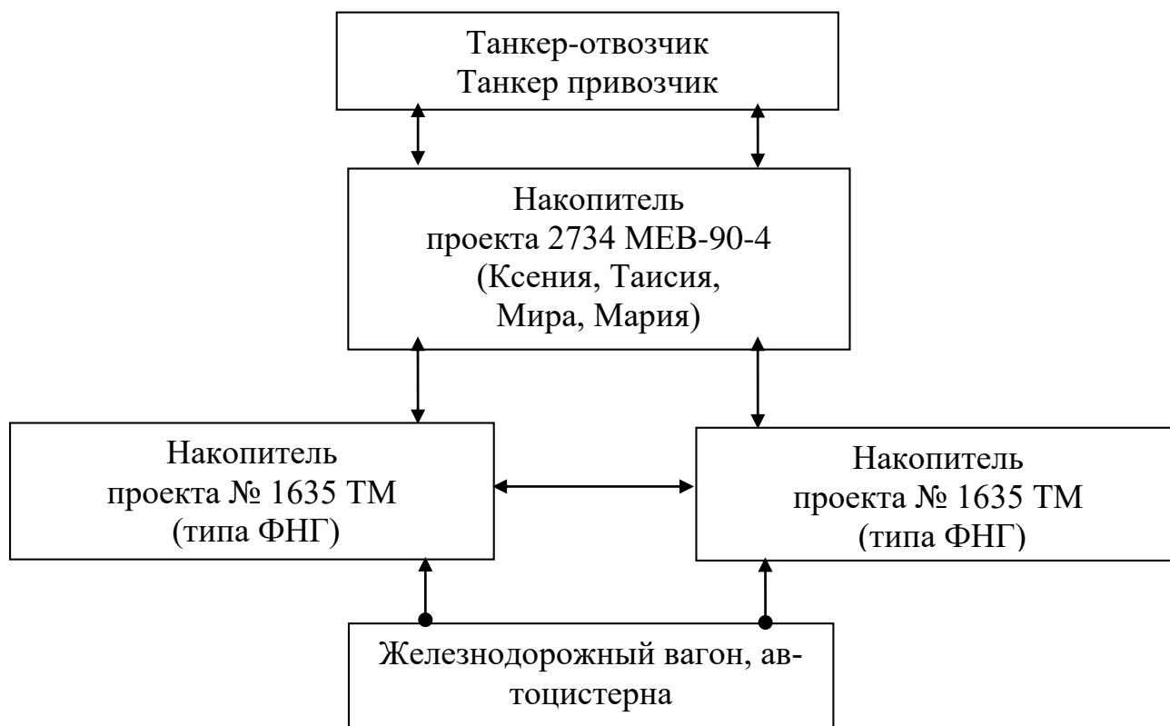
Рисунок 4.1.1.2 - Схема перегрузки на причале СВ-15
