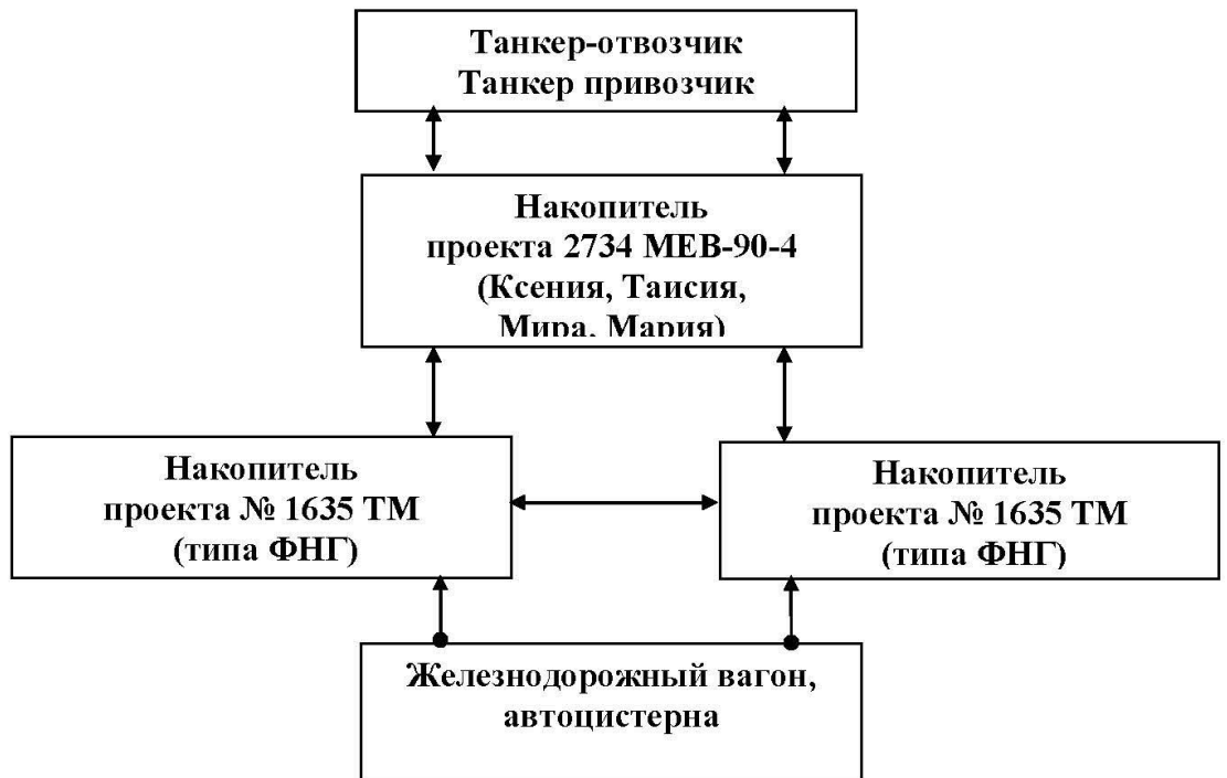
Рис. 4. Схема перегрузки на причале СВ-15.
